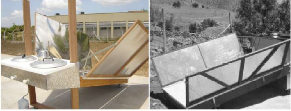
الشكل 16: الطباخات الشمسية غير المباشرة مع مجمع شمسي مسطح في تشيلي (1) وفي البرازيل (2)
